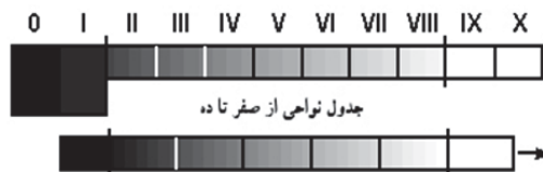
شکل ۶. ظهور مثبت- در این مورد برای انتقال ناحیه شش سوژه به ناحیه هشت، ظهور به صورت مثبت دو (به اضافه دو) انجام می گیرد (واعظ، ۱۳۸۹).
