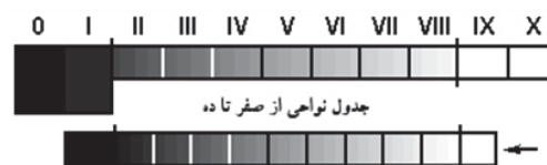
شکل ۴. ظهور منفی- کنتراست سوژه با جدول نواحی مطابقت ندارد؛ کنتراست بالا و نیازمند کاهش است. ناحیه هشت سوژه باید یک پله پایین تر و به ناحیه هفت روی جدول منتقل شود. ظهور منهای یک، ظهوری مناسب برای کاهش کنتراست است (واعظ، ۱۳۸۹).
