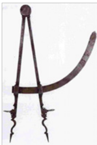
تصویر ۳۳. پرگار تقسیم، سده ۱۳ هجری، ابعاد با‌ترین حالت ۱۸/۴*۲۷/۳ سانتی‌متر، طول پایه ۲۵/۳۹ سانتی‌متر، طول نوک ۵/۶۶ سانتی‌متر، رادیوس ریل ۱۵/۷۹ (مادیسون و ساواژ اسمیت، ۱۳۸۷: ۳۰۱)
